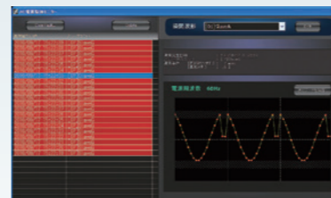
AC電源監視モニター画面
